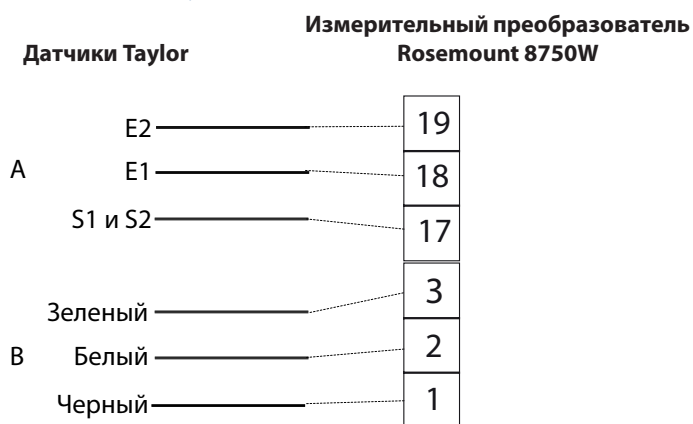
Рисунок D-19. Общая схема электрических соединений для подключения датчиков Taylor к измерительному преобразователю Rosemount 8750W
